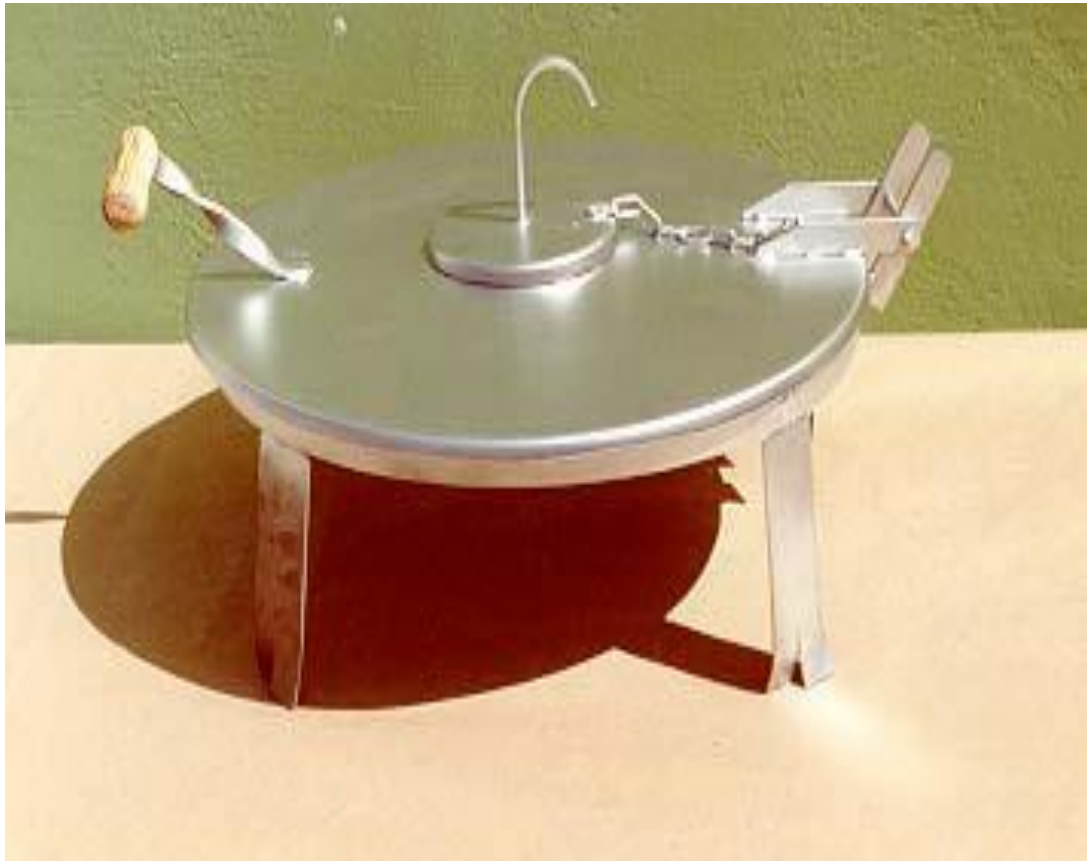
Photo 3. Couverture métallique conçue pour la Tabouna visant l'amélioration du rendement thermique.
